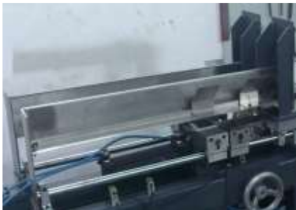
Fig.12. Pipe Inserting Subassembly
